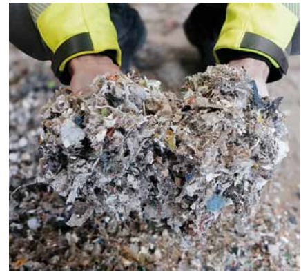
Endzustand: Homogenes Ausgangsmaterial ohne Überlängen
