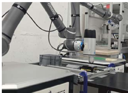
Automatisierte Demontage eines Batterie-Moduls im Fraunhofer IWKS Robotik-Lab
