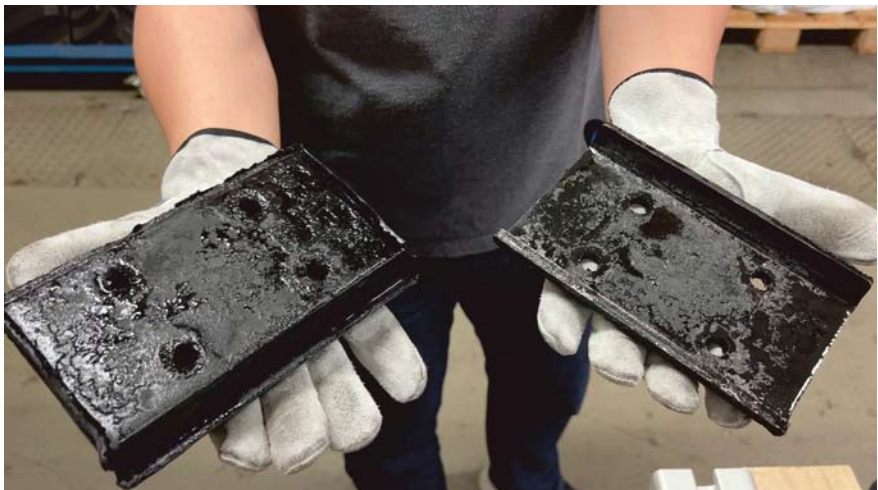
Getrennter Gummi-Metall-Verbund nach Behandlung mit dem neu entwickelten Verfahren
