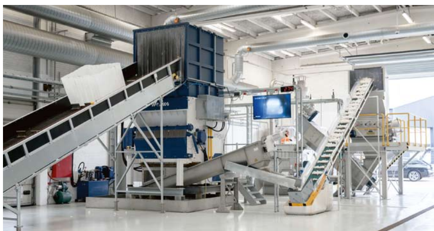
Die neue Recyclinglinie bei Dansk Emballage: ein WEIMA W5.18, ein Granulator und eine Friktionswaschanlage
