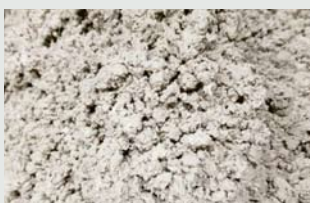
Restfasern Rückgewinnung der Restfasern aus dem Input-Material
