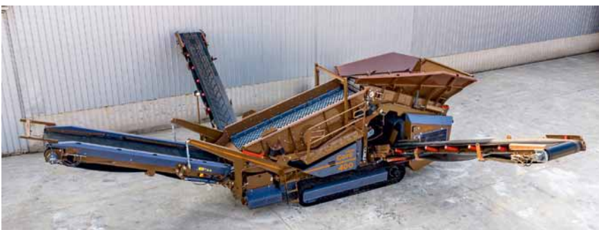
Der CoreVibro 400 ist für schwerste Sieb-Anwendungen ausgelegt
