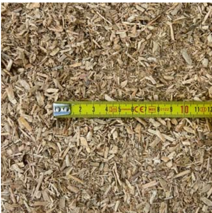
Altholzspäne nach der Zerkleinerung
