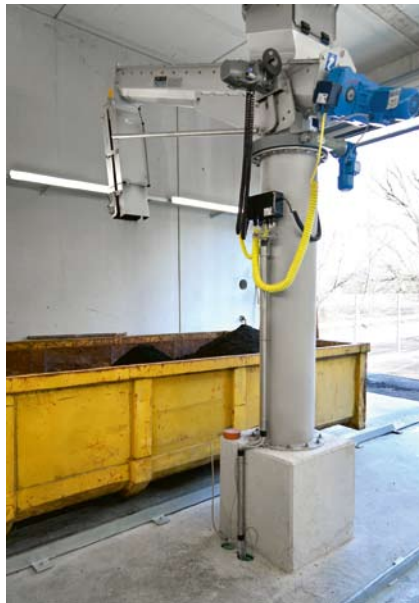
Trogförderschnecke Containerverteiler Ro8 TC mit Höhenstandmessung und motorischen Schwenk- mechanismen
